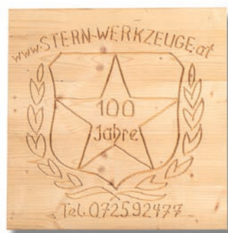
Freihand - Anwendungsbeispiel für Schriftenfräser 562AE/VHW-8/60
